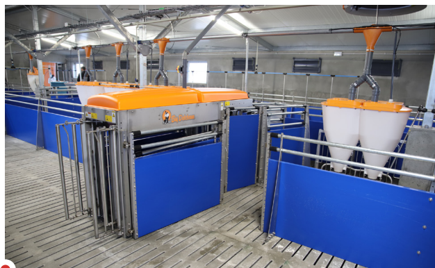
Stać kontrola masy wszystkich zwierząt, możliwość pozyskania w każdej chwili informacji o dziennych przyrostach oraz znaczna oszczędność czasu podczas załadunku to tylko niektóre zalety wagi sortującej TriSort pro
